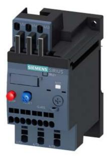
OVERLOAD RELAY 1.1...1.6 A FOR MOTOR PROTECTION SZ S00, CLASS 10, STAND-ALONE INSTALLATION MAIN CIRCUIT: SPRING TERMINAL AUX. CIRCUIT: SPRING TERMINAL MANUAL-AUTOMATIC-RESET
