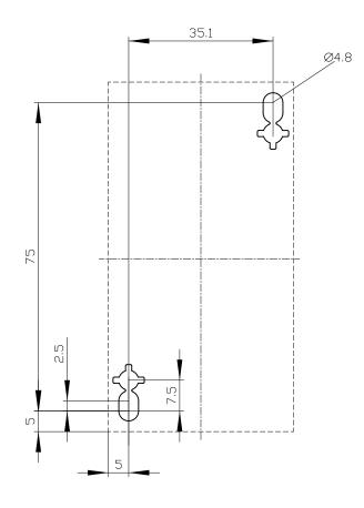
Alle Bemassungswerte sind in Millimeter (mm) angegeben. All dimensions are in millimeters (mm)
