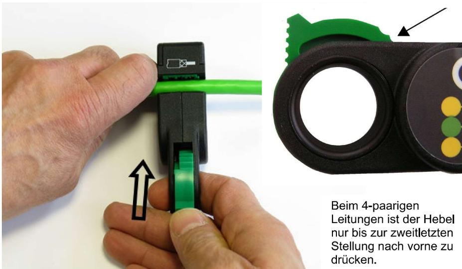
5. Drehen Sie das Abisolierwerkzeug zum Abisolieren des Kabels in Pfeilrichtung.
