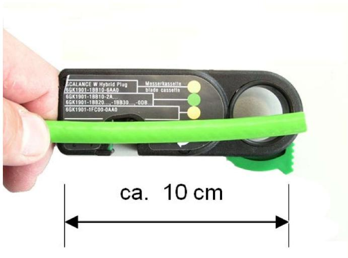
3. Legen Sie das Kabel in das Abisolierwerkzeug ein. Achten Sie darauf, dass eine Länge von etwa 10 cm abisoliert wird.
