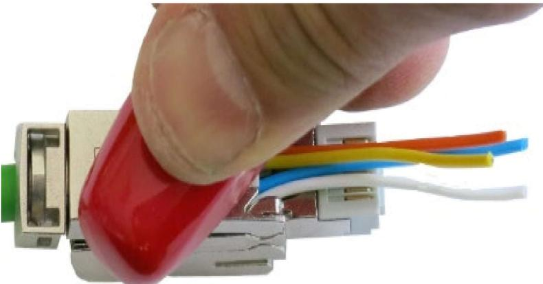
5. Drehen Sie das Verschlussstück in Pfeilrichtung soweit, wie dies von Hand möglich ist.
