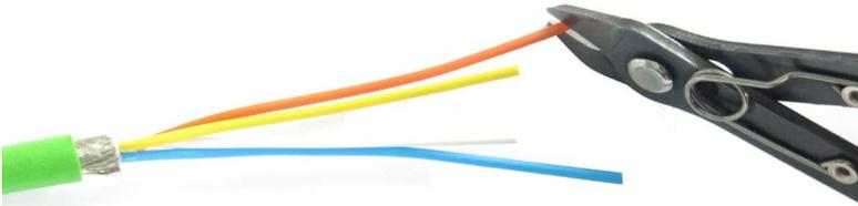
2. Führen Sie die Adern entsprechend den Farben (siehe Rahmen) am Stecker ein. Achten Sie darauf, dass der Kabelschirm auf den Schirmkontakten und der Mantel auf die Zugentlastungsdorne des Steckers aufgelegt sind.
