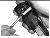
Entnehmen Sie nach dem Entspannen des Werkzeugs die im Werkzeug verbliebenen Leitungsreste.
