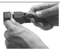
Legen Sie das abgemessene Leitungsende in das Abisolierwerkzeug. Anschlag für die Leitungslänge ist der Zeigefinger der linken Hand.
