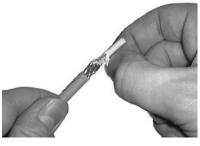
Falls beim Abisoliervorgang die weiße Füllmasse nicht mit entfernt wurde, entfernen Sie diese durch Abziehen von Hand.
