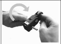
Drehen Sie das Abisolierwerkzeug zum Abisolieren der Leitung bei -PVC-Isolierung ca. 4 mal, -PUR-Isolierung ca. 8 mal in Pfeilrichtung.
