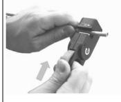
5. Spannen Sie das Abisolierwerkzeug bis zum Anschlag.
