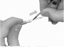
Die Schutzfolie lässt sich leichter entfernen, wenn Sie diese zwischen den Adern mit einem Schraubenzieher anritzen.
