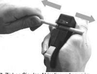
Ziehen Sie das Abisolierwerkzeug im geschlossenen Zustand mit den Mantelund Schirmresten vom Leitungsende ab.
