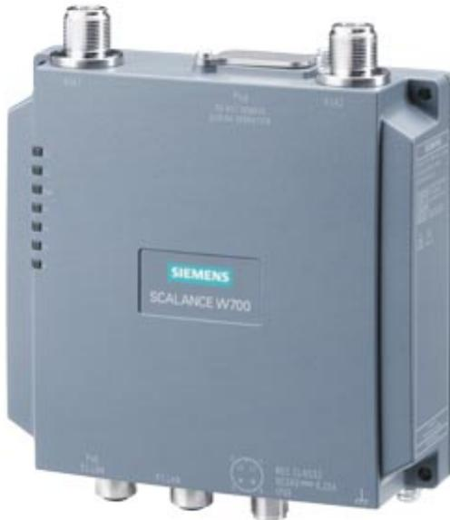
IWLAN Access Point, SCALANCE W778-1 M12, 1 Radio, 2 N-CON-Antennenanschluss, iFeatures support via KEY-PLUG, IEEE 802.11a/b/g/h/n, 2,4/5GHz, brutto-Data-Rate 300 MBit/s, 2x M12 max. 100 MBit/s, PoE integrierter 2-Port-Switch, Redundant DC 24V, M12 A-Kodiert IP65, -20... 60°C, Plug-Schacht WPA2/802.11i/e, Länderzulassungen beachten! CERT ID: MSN65-W1-M12-E2
